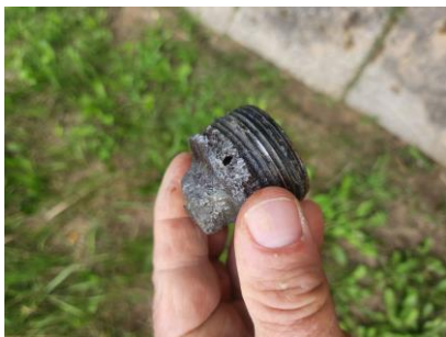
Ursache war ein Stahlzapfen, welcher ohne Korrosionsschutz eingebaut wurde
